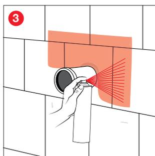
Sprühen sie den Sprühprimer gleichmäßig auf den eingezeichneten Bereich.
