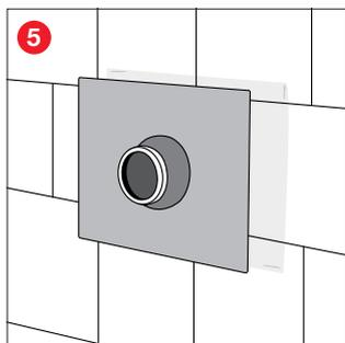
Ziehen Sie die Manschette über die Durchführung. Entfernen Sie die Schutzfolie.
