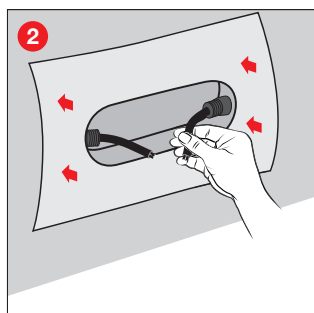
Kabel schräg anschneiden und die integrierten DICTStopfen durchstoßen.
