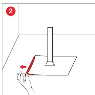
2 Entfernen Sie die Schutzfolie unter einer Seite des Klebekragens.
