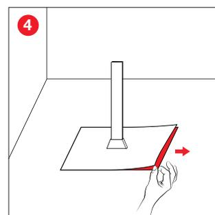
4 Entfernen Sie die Schutzfolie unter der anderen Seite des Klebekragens.
